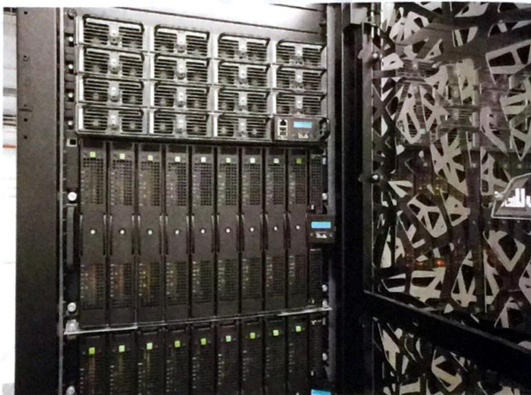
Os grandes compartimentos verticais protegidos por portas metálicas e acesso por um corredor central reúnem tecnologia sofisticada, em uma máquina com alto poder de desempenho: só de processadores há mais de 19 mil, dispostos sobre racks e conectados por um amontoado de fios coloridos, a memória RAM é de 53 terabytes (treze mil vezes maior que a de um computador comum)
